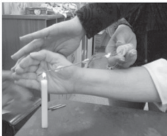
Figura 1 - Experimento com materiais de baixo custo: a condução do calor em um fio metálico e uma vela. Fonte: Liliane Ribeiro, 2011.
